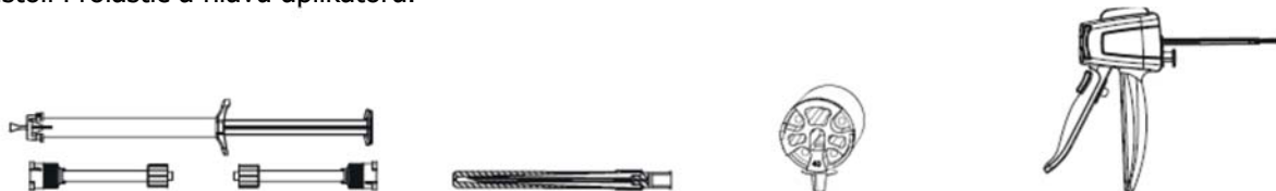
Injekční stříkačka a statické směšovače 2 x Jehla Hlava aplikátoru Dávkovací pistole
